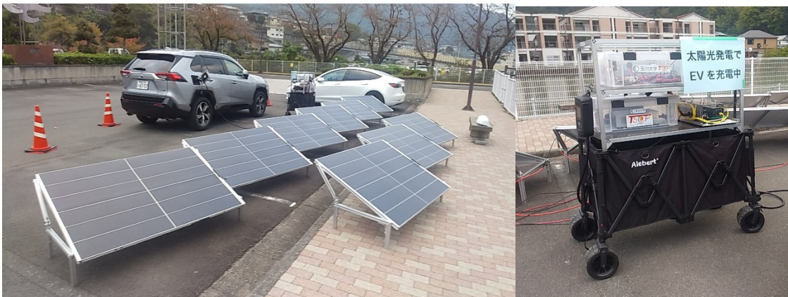
太陽光発電による電気自動車 (EV) への充電の様子 (玉川大学)
