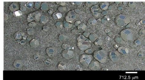
図3. 製錬された金属 Mg の拡大写真
