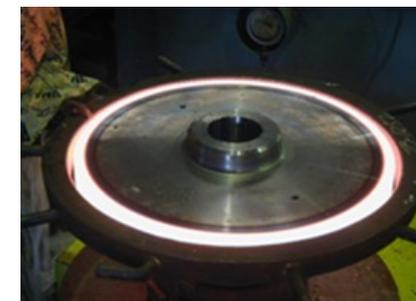
非接触で被加熱物を**直接加熱**
